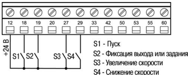
Рисунок 4.3 – Схема подключений для конфигурации «Управление скоростью АД с помощью цифровых входов»
