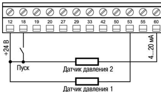
Рисунок 4.12 - Схема внешних подключений ПЧВ
