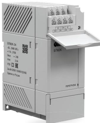
ОВЕН БП60К предназначен для питания стабилизированным напряжением 24 В программируемых контроллеров ОВЕН ПЛК и модулей ввода/вывода ОВЕН Мх210. Компактное исполнение и широкий функционал позволяют эффективно применять его и совместно с другими приборами.
