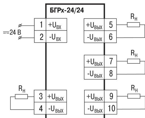
**Внимание!** Питание блока следует осуществлять от локального источника питания подходящей мощности, например: ОВЕН БП07, БП15 и др., установленного в том же шкафу электрооборудования, в котором устанавливается блок.
