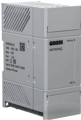
ОВЕН ИБП60ЖД-24 предназначен для использования в качестве резервированного источника питания при работе от источника постоянного тока 24 В или от РСП (резервная сеть питания) ЖД-станций с напряжением 28...43 В. Прибор предназначен для применения в системах промышленного назначения, а также в рамках следующих подсистем инфраструктуры железнодорожного транспорта:
