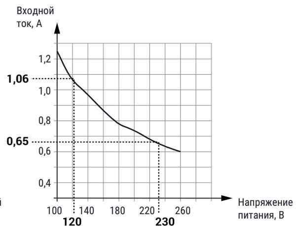
График зависимости входного тока от входного напряжения источника бесперебойного питания ИБП60Б (без АКБ)
