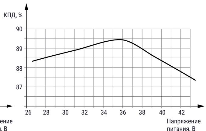
График зависимости КПД от напряжения питания (от АКБ)
