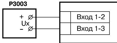
**Рисунок 8.5 – Схема подключения компаратора напряжения при юстировке**
