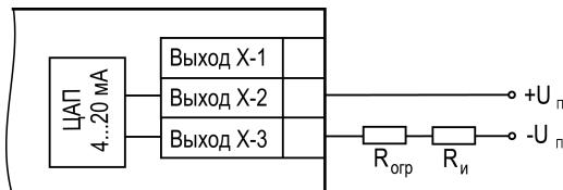
**Рисунок 5.19 – Схема подключения нагрузки к ВУ типа И**
