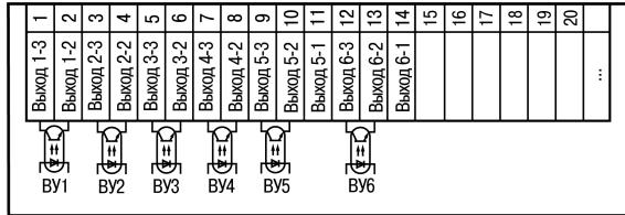
Рисунок 5.13 – Схема подключения транзисторных оптопар прибора TPM136-К
