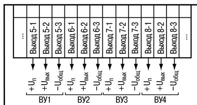
Рисунок 5.21 – Схема подключения выходных устройств прибора TPM 13x-U
