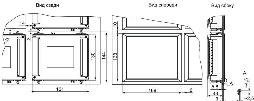
**Рисунок 4.3 – Прибор в корпусе Ш7, установленный в щит толщиной 3 мм**
