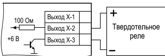
**Рисунок 5.17 – Схема подключения нагрузки к ВУ типа Т**
