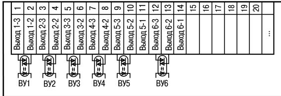
**Рисунок 5.16 – Схема подключения симисторных оптопар прибора TPM136-С**
