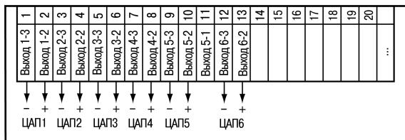
**Рисунок 5.18 – Схема подключения твердотельных реле прибора TPM136-Т**
