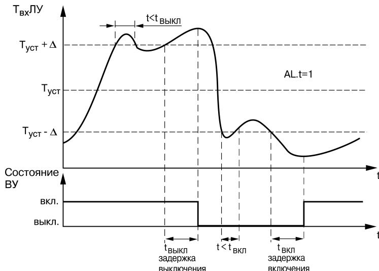
**Рисунок 7.7 – Работа ЛУ с задержками включения и выключения**
