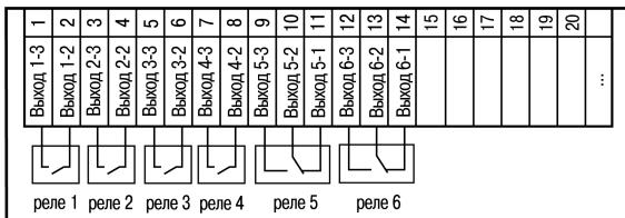
Рисунок 5.11 – Схема подключения электромагнитных реле прибора TPM136-Р
